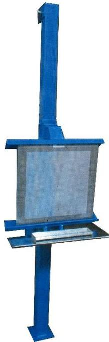
Questa attrezzatura è stata realizzata per permettere all'utilizzatore di applicare manualmente l'emulsione agli schermi serigrafici in modo semplice ed accurato.
